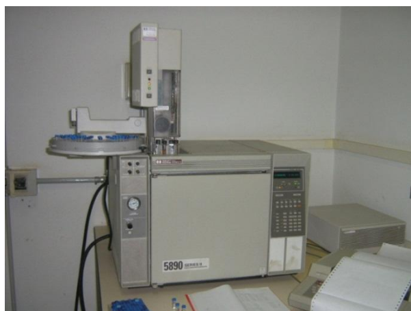
Figura 20 – Cromatógrafo líquido-gasoso (Hewlett Packard 5890 Sries II GC), equipado com integrador e injetor automático, utilizado para determinação da concentração de AGCC.
