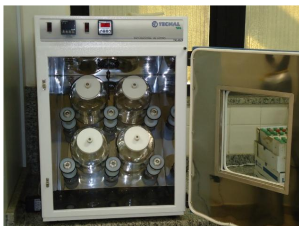
Figura 16 – Incubadora in vitro modelo TE-150 (Tecnal), utilizada para estimativa da digestibilidade ruminal e intestinal da PB.
