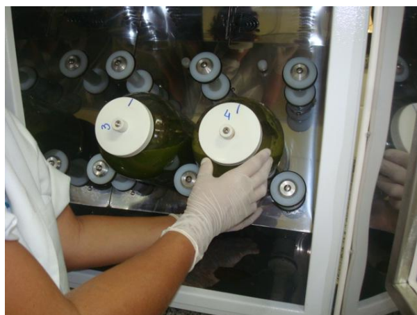
Figura 18 – Incubação das amostras em Incubadora in vitro modelo TE-150 (Tecnal).
