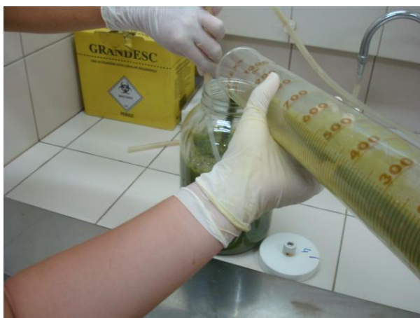
Figura 17 – Inoculação das amostras para estimativa da digestibilidade ruminal e intestinal in vitro da PB.
