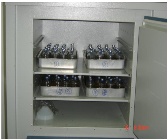
Figura 11 – Incubação das amostras em estufa com circulação forçada de ar a 39°C.
